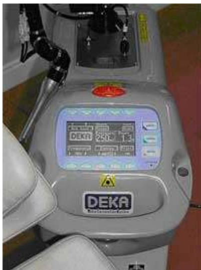
Fig 1. Pantalla de computadora del equipo de láser Er:YAG, en donde se gradúa la frecuencia, la energía y la potencia en Wattios, con la cual se va a trabajar. (Fuente: Propia.)
