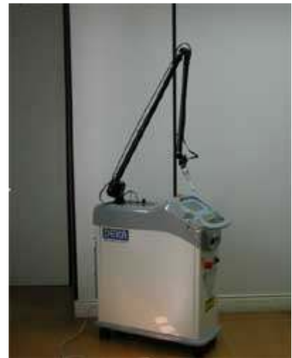
Fig. 4. Imagen del láser Er:YAG de la compañía DEKA, donde se observa el brazo articulado. (Fuente: propia).
